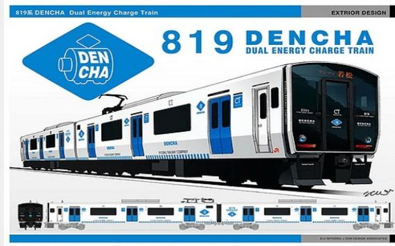
筑豊本線に導入される架線式蓄電池動力の通勤型車両819系、通称「DENCHA (DUAL ENERGY CHARGE TRAIN)」
